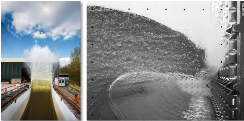
Onderzoek naar het klotsen van LNG
